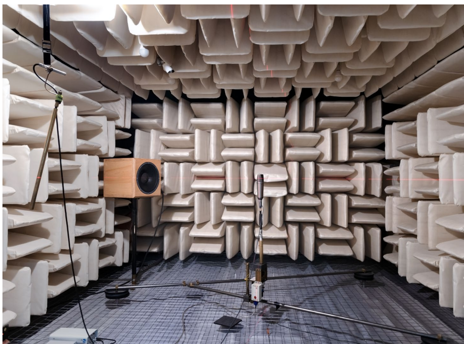
Für akustische Messungen steht dem Neumann-Service ein reflexionsarmer Raum zur Verfügung.
