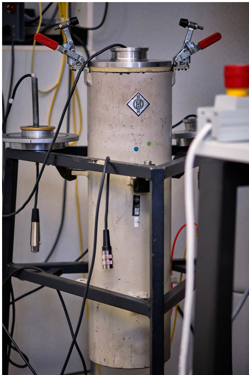
Das Mikrofon-Eigenrauschen wird in einem schalldichten Behälter (Rauschbombe) gemessen.
